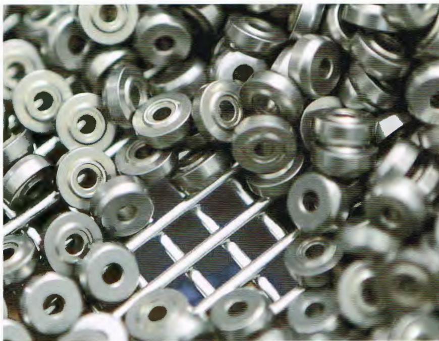
Die geringe Maschenweite von nur 4 mm ermöglicht eine effiziente Reinigung von Kleinteilen als Schüttgut.
