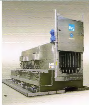
Die Anlage ist konzipiert für Bauteile mit hohen Gewichten und großen Chargendichten in Körben oder auf Härterosten.
