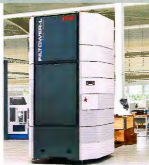
Die Filtower 4.0-Reihe erfasst neben Schweißrauch und Staub auch Ölnebel in Produktionshallen.
