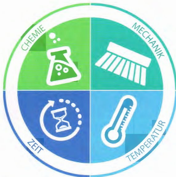
Wechselseitiges Verhältnis der vier Reinigungsfaktoren Chemie, Mechanik, Temperatur und Zeit. (Bild: Mafac)
