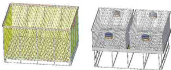
Sonderwarenkorb für Großteile und Untergestell zur Adaption von Standard MEFO-BOXen auf die Sonderchargengröße.
