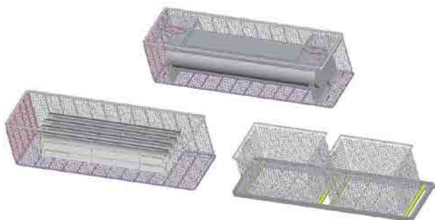
Sonderwarenkorb mit teilespezifischen Aufnahmen für Großteile und Adapterrahmen zur Adaption von Standard MEFO-BOXen auf die Sonderchargengröße. (Bild 1)
