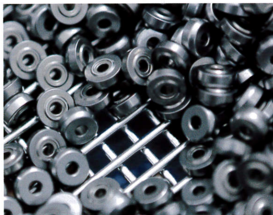
Mit den neuen «Mefo»-Boxen mit einer Maschenweite von 4 mm lassen sich Kleinteile effizient als Schüttgut reinigen.
