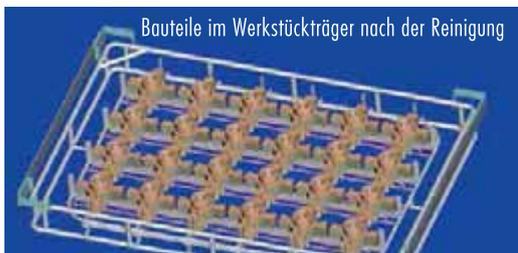
Bauteile im Werkstückträger nach der Reinigung
