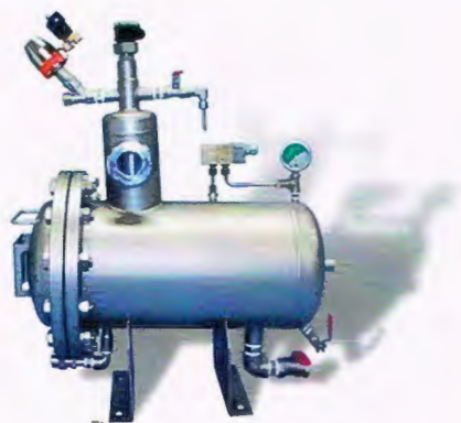
Bild: Kleinste Ausführung des MESB - Mechanischer Emulsions- und Schaumbrecher zur Entfernung von Fremddöl aus Waschwasser (Werkbild: Mahle Industriefiltration GmbH, Öhringen)
