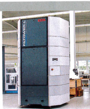
Die Filtover 4.0-Reihe erfasst neben Schweißrauch und Staub auch Ölnebel in Produktionshallen.
