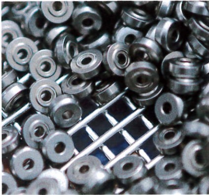
Bild 1: Mit den neuen MEFO-BOXen in Maschenweite 4 mm können Kleinteile effizient als Schüttgut gereinigt werden
